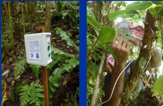
Capteurs de température et humidité (« dataloggers » 1h/2 ans)
